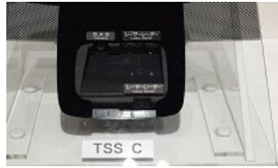
赤外線レーザーと光学カメラの一体型センサー
