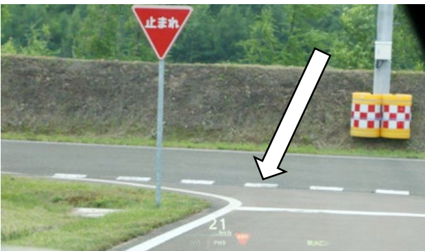
道路標識を認識したことを示すヘッドアップディスプレイ
