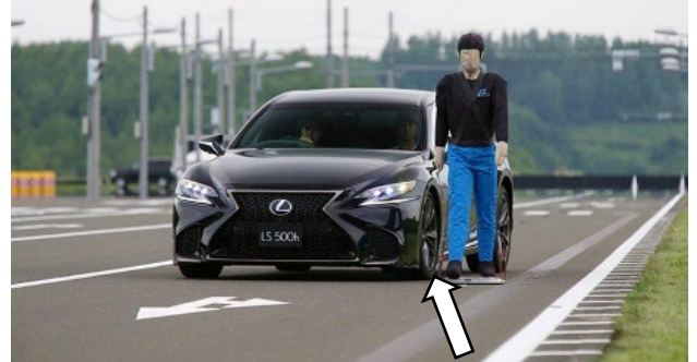
歩行者との接触をステアリング操舵と制動で抑制する衝突被害軽減ブレーキ
