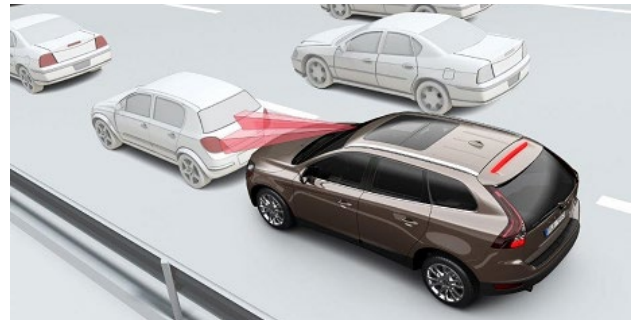
衝突被害軽減ブレーキの作動概念
