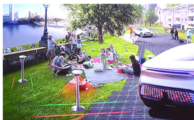
レーザー照射技術で走行可能区域を限定
