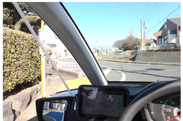
柱が邪魔をしてカーブミラーや標識が見えない
