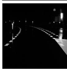
AWTは雨天時の反射エレメントと大粒径ガラスビーズを混合した特殊反射素子を散布することにより、雨天時・晴天時ともに優れた視認性を提供します。
